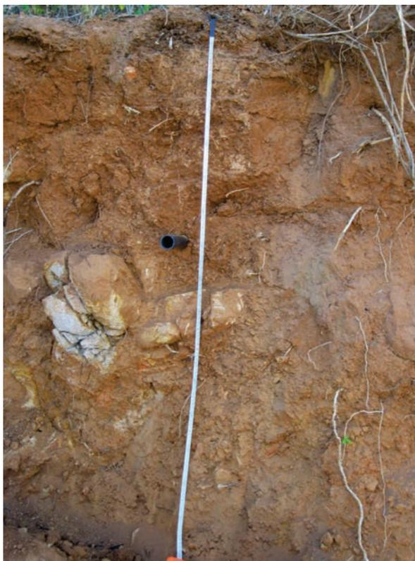
Figura 7 – Tubo PVC introduzido em perfil para coleta de amostra para datação por LOE de colúvios da Serra da Baixa Verde, Pernambuco. O material amostrado precisa ser protegido da luz para evitar o “zeramento” da amostra pela exposição à luz.
