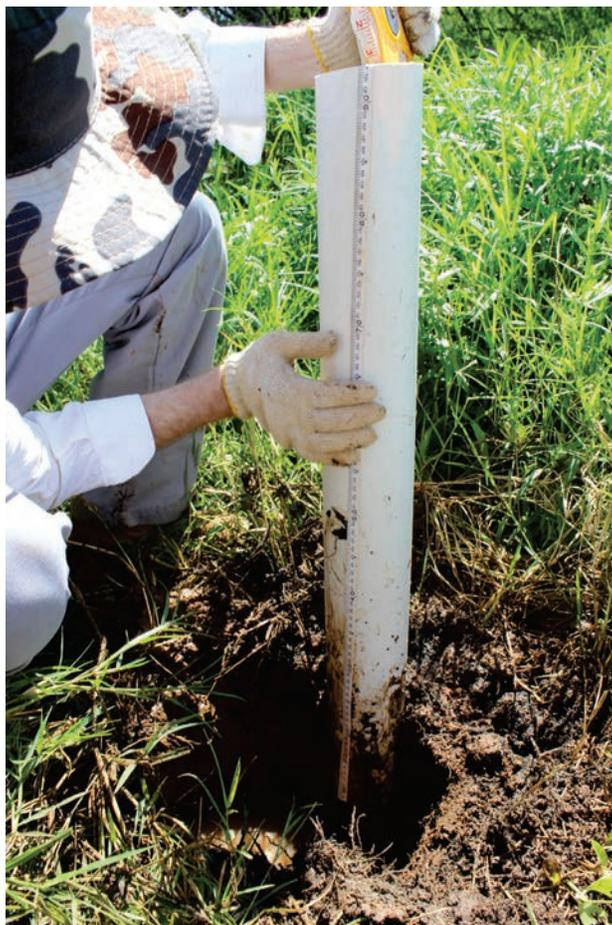
Figura 5 – Coleta de amostra em sedimentos de colmatação de açudes no maciço da Serra da Baixa Verde, semiárido de Pernambuco.
