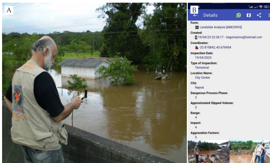
Figura 3 – Aplicativo Vicon SAGA Mobile para coleta de dados em campo. 3A – Avaliações de deslizamentos por equipes de campo em Teresópolis – RJ; 3B – Plataforma de coleta e envio remoto de dados estruturados em formulários eletrônicos a partir de dispositivos móveis.
