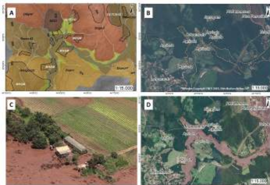
Figura 7 – Mapa geomorfológico e ilustrações com a mancha de lama acomodada na planície fluvial no Ribeirão Ferro-Carvão: A – Fragmento do mapa geomorfológico apresentado na Figura 5; B – Imagem de Satélite da PLEIADES capturada no dia 18/01/2019; C – Imagem aérea após o rompimento da Barragem I, com rejeito de minério de ferro recobrendo terrenos artificiais destinados à agricultura.
