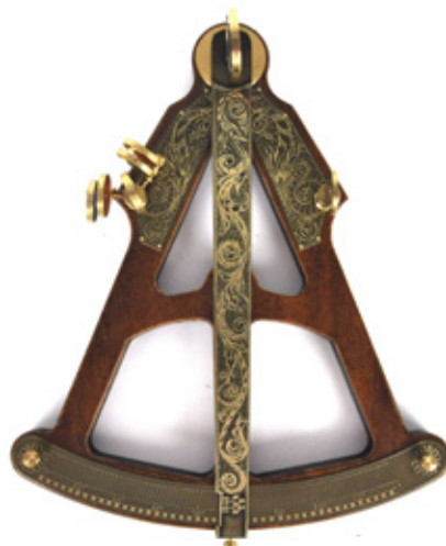
Instrumento náutico, o sextante determina o ângulo entre um objeto celeste e o horizonte
