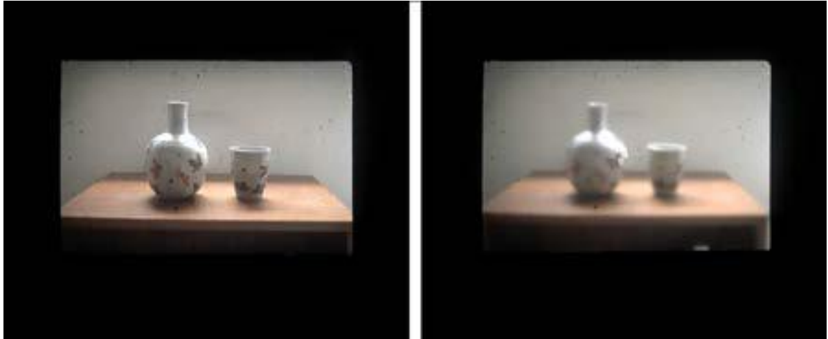
Figura 4 Fotografia feita a partir do visor da câmera SLR Nikon F mostrando a imagem em foco (à esquerda) e fora de foco (à direita) Fotos do autor
