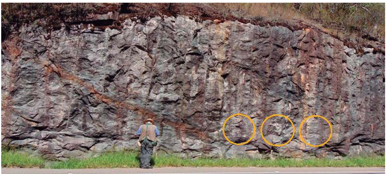
Figura 3 Afloramento do ortognaisse na RJ-130 sentido Teresópolis – Nova Friburgo. Os círculos traçados têm 1 m de diâmetro e estão espaçados 1,5 m de seus respectivos centros.
