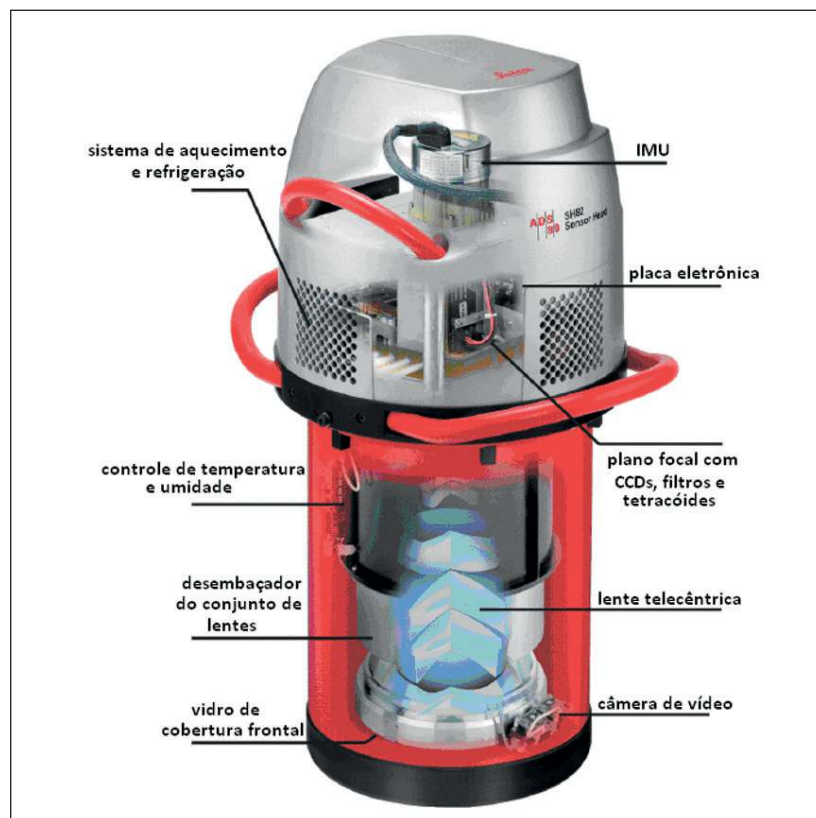
Figura 3 Câmara ADS-80. Fonte: Leica Systems, 2010.
