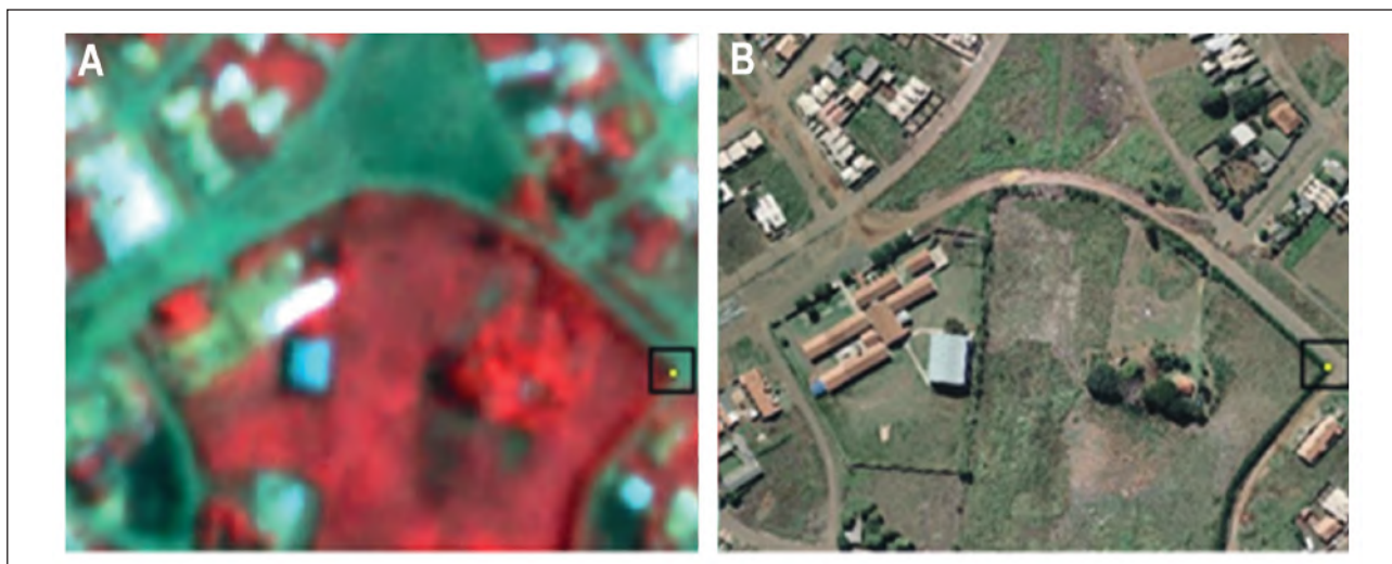
Figura 3 Medição de pontos correspondentes no QGIS: (A) Imagem Planet (GSD de 3,7 metros); (B) Ortoimagem aérea (GSD de 10 cm).
