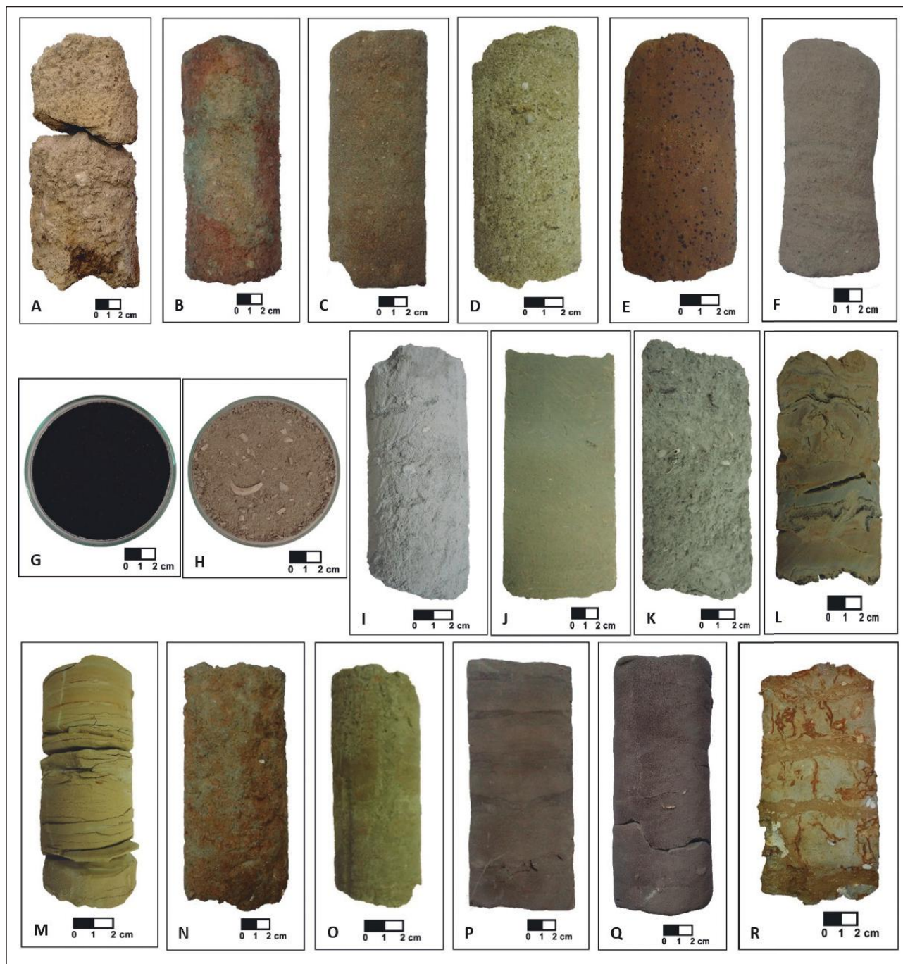
Figura 2 Principais aspectos das fácies sedimentares sintetizadas para os testemunhos dos poços 2-TO-1-RJ, 2-MU-1-RJ e 2-BG-1-RJ. (A) Fácies Cm (conglomerado fino, sustentado pelos clastos, maciço); (B) Fácies ACm (arenito conglomerático maciço); (C) Fácies ALm (arenito lamoso maciço); (D e E) Fácies Am (arenito maciço). Em (E) destaca-se um arenito maciço intensamente oxidado com siderita eodiagenética, sua ocorrência marca um desenvolvimento incipiente de paleossolos associados a episódios de exposição subaérea; (F) Fácies Ae (arenito com estratificação cruzada); (G) Fácies Amo (areia com matéria orgânica); (H) Fácies Ab (areia com bioclastos); (I) Fácies Ah (arenito carbonático maciço); (J) Fácies Ahf (arenito argiloso híbrido, maciço, com fitoclastos); (K) Fácies Ahg (arenito híbrido maciço, com grânulos); (L) Fácies If (intercalações entre argilito e arenito ricos em fitoclastos); (M) Fácies Ih (intercalações entre lamito híbrido e arenito); (N) Fácies LAm (lamito arenoso maciço); (O) Fácies Lm (lamito maciço); (P) Fácies LI (lamito laminado); (Q) Fácies Lb (lamito maciço com bioclastos); e (R) Fácies Lh (lamito carbonático maciço), observe o grau de oxidação e a presença de marcas de raízes, sugerindo o desenvolvimento incipiente de paleossolos associados a episódios de exposição subaérea.
