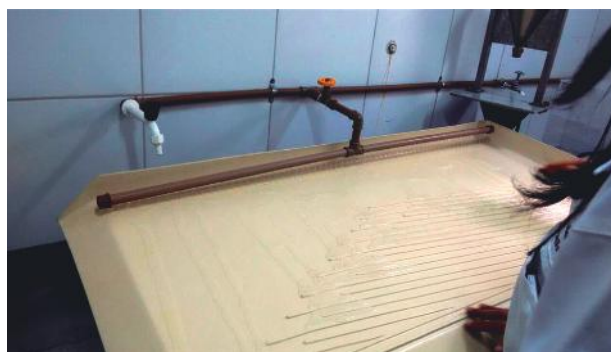
Figura 4 Mesa concentradora do tipo Wilfley Table , com adaptações, na CPRM-Salvador.
