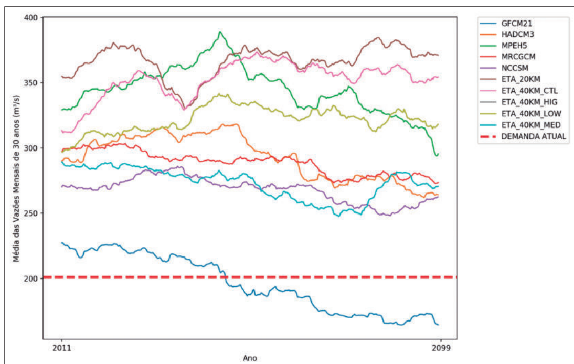
Figura 2 Comparação das vazões médias mensais (m 3 /s) para períodos de 30 anos da Estação Santa Cecília (2011-2099).
