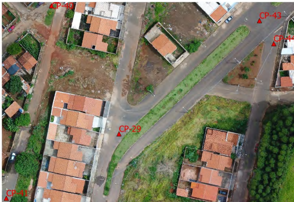
Figura 5 Exemplo da disposição de quatro pontos de verificação utilizados na classificação da ortofoto.
