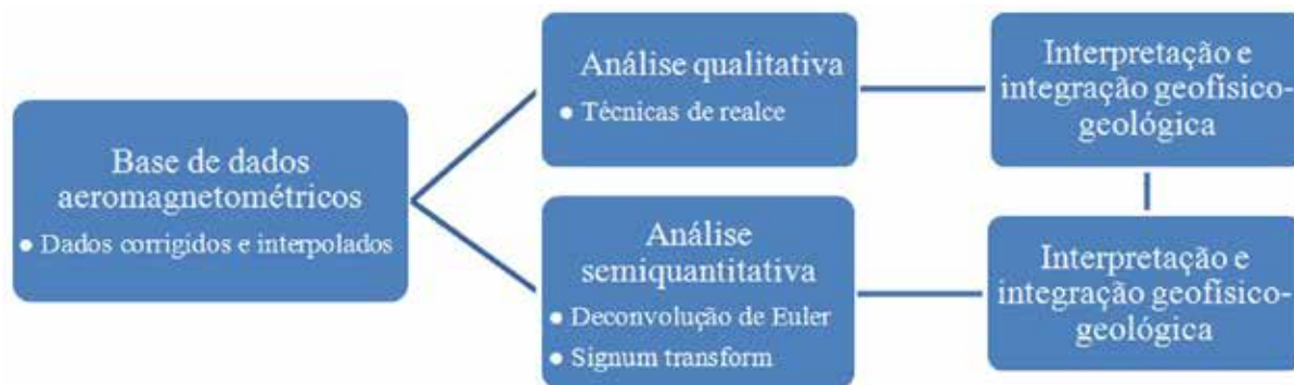
Figura 5 Fluxograma do processamento de dados aerogeofísicos utilizado na pesquisa.
