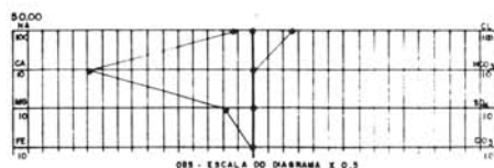
Figura 17 - Padrão de diagrama de Stiff para as águas-de-formação pertencentes à Formação Lagoa Feia .
