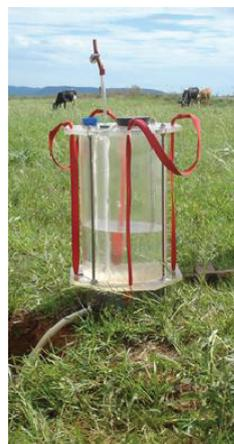
Figura 3 Método Cornell Sprinkle Infiltrometer em uma área de pastagem na bacia hidrográfica do Vacacai-Mirim.
