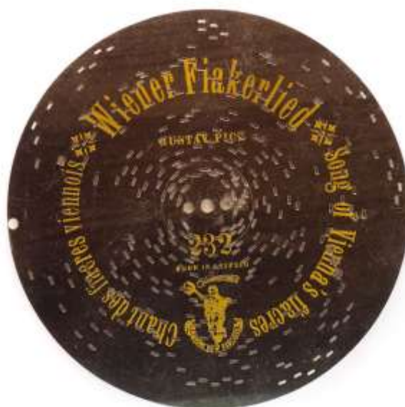
Figura 4 – Disco perfurado para polyphon da firma Polyphon-Musikwerke-AG de Leipzig, com a programação da melodia de Gustav Pick (1832-1921) intitulada Wiener Fiakerlied , “Chant des fiacres viennois / Song of Vienna’s fiacres” (Canção dos cocheiros de Viena).
