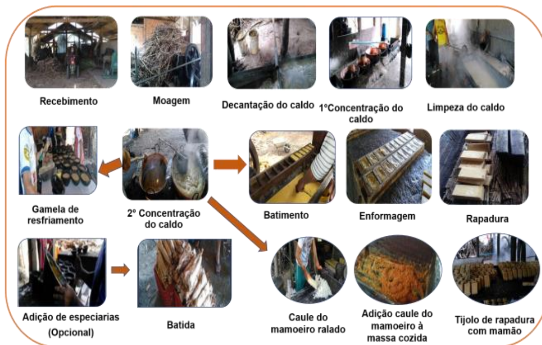
Figura 3. Fluxograma da produção artesanal de rapadura, batida e tijolo nos engenhos da localidade de Sítio Moitinga, Ubajara, CE
