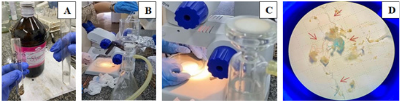
Figura 4. Estômago de peixe marinho a ser digerido com peróxido de hidrogênio (digestão ácida) (A). Filtração do estômago já digerido (B). Inspeção de MPs sob estereomicroscópio (C). As setas mostram fibras encontradas em um conteúdo estomacal (D). Fotografias por Ariane Oliveira.
