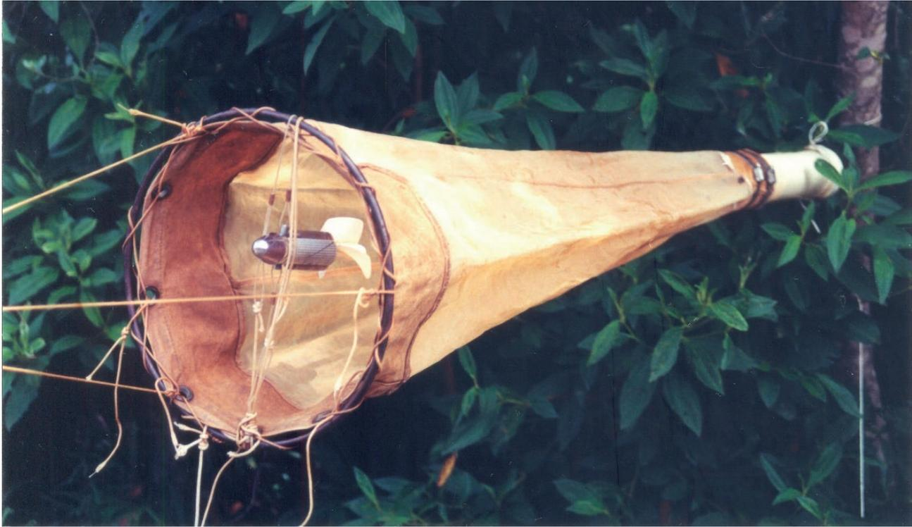
**Figura 4.** Rede de ictioplâncton com fluxômetro acoplado para coleta de ovos e larvas de peixes em riachos com vazão alta.
