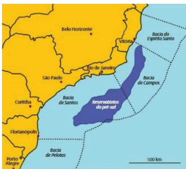
Figura 4: “Distribuição das rochas reservatórios do pré-sal (em azul) em relação às bacias sedimentares da margem continental brasileira” (RICCOMINI, SANT’ANNA; TASSINARI, 2012).
