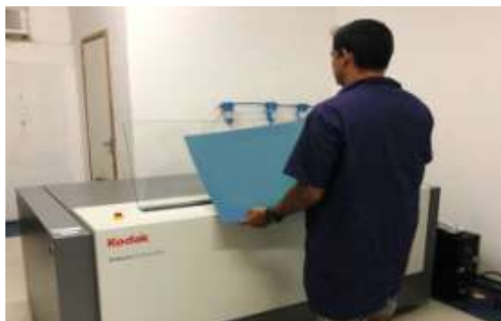
Gravação de chapas através do método CTP ( computer to plate )
