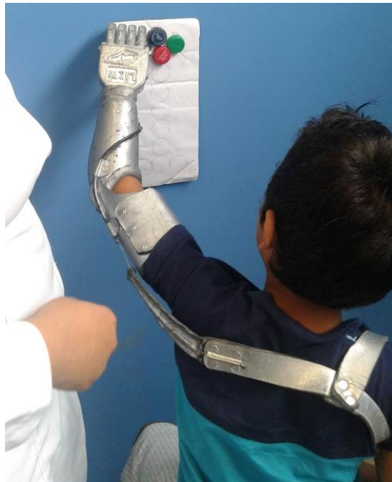
Figura 5: Prótese mecânica para amputação transradial proximal com suspensão (Fonte: Arquivo pessoal)
