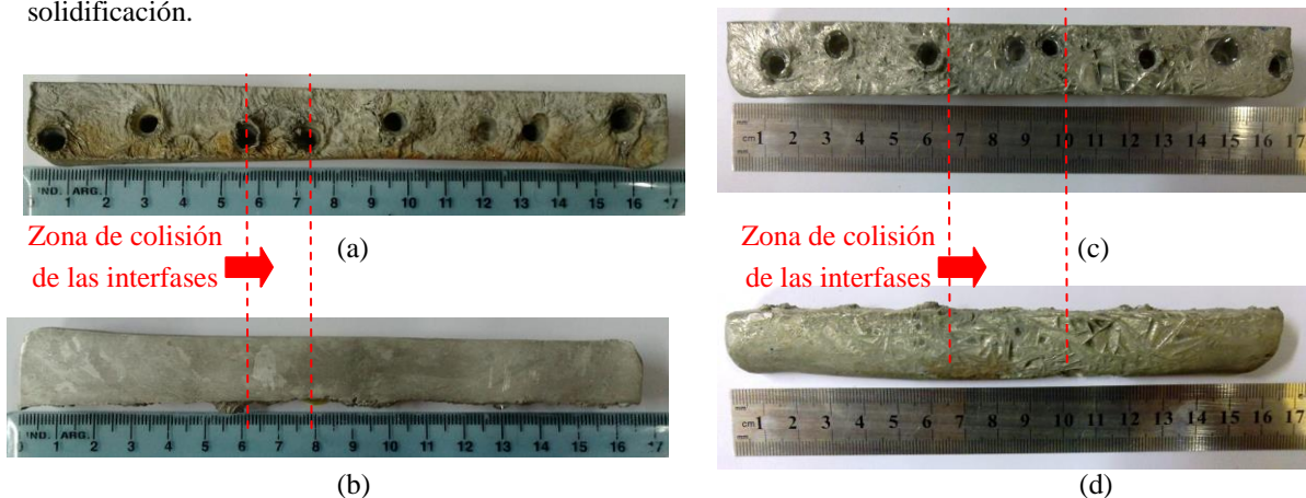
Figura 6: (a) y (c) Probetas de Sn-6%Zn y Sn-15%Zn. (b) y (d) Macrografías de Sn-6%Zn y Sn-15%Zn.
