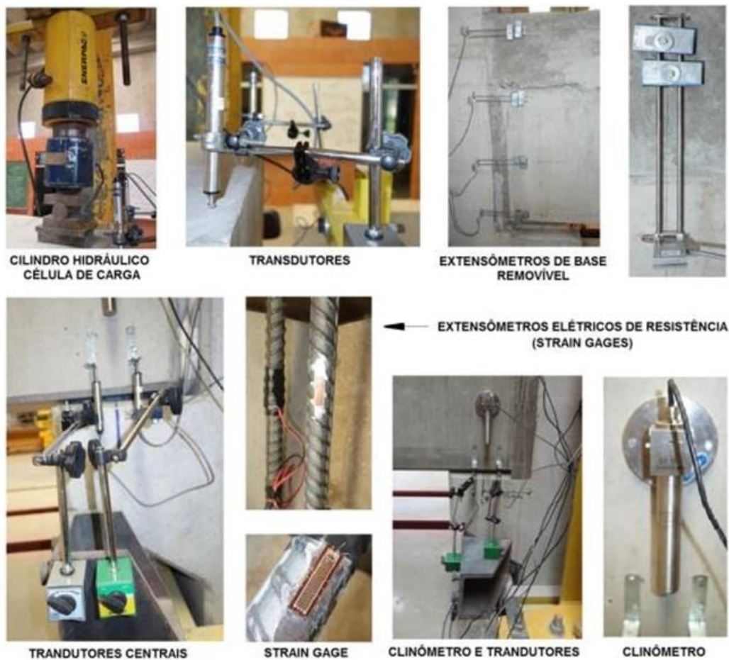
Figura 8: Detalhe dos instrumentos empregados nos ensaios.
