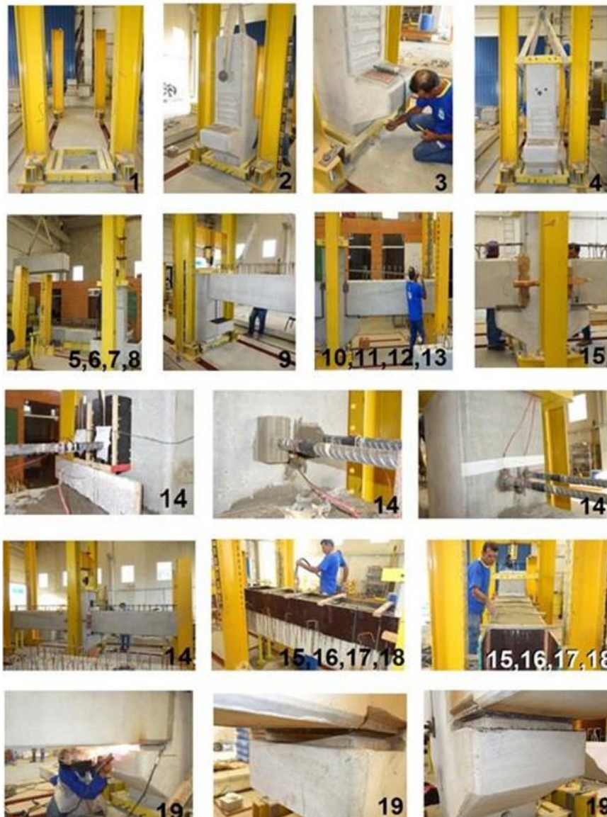
Figura 6: Sequência de montagem dos modelos.
