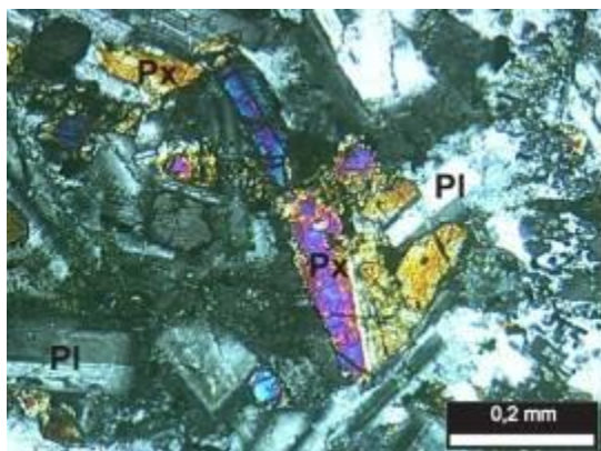
Figura 3: Rocha II: basalto – fenocristal de clinopiroxênio (augita - Px) no centro da fotomicrografia, com macla lamelar. À direita, após cristal de plagioclásio (Pl), matriz fina (quartzo + feldspato potássico, em textura micrográfica).
