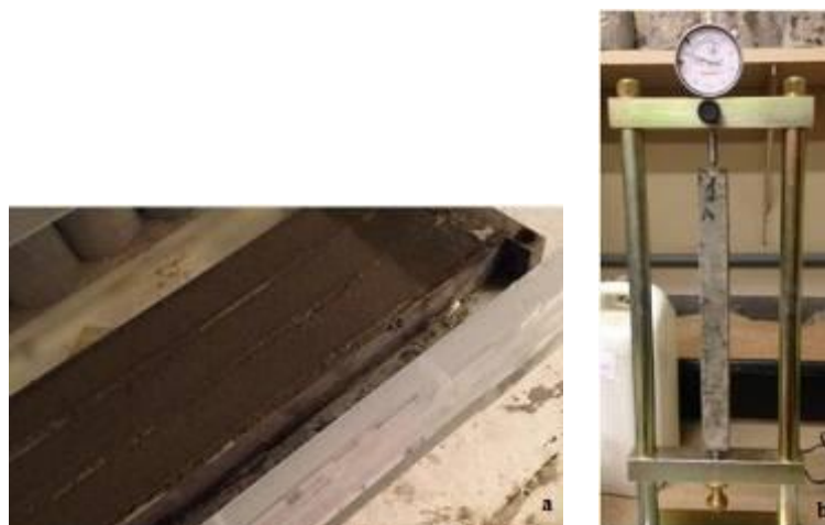
Figura 1: a) Moldagem dos corpos de prova de argamassa; b) Leitura da expansão com auxílio de relógio comparador.
