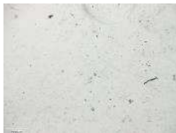
Figura 9: Microscopia ótica das MQ na magnificação de 80x, evidenciando a não presença de poros visíveis.
