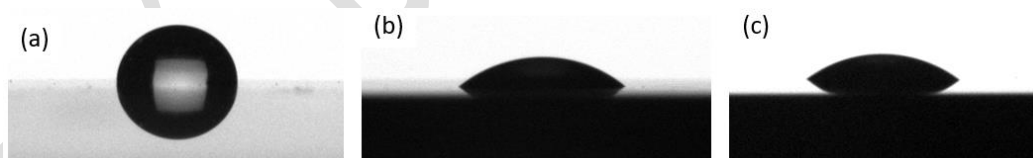
Figura 7: Ensaio de ângulo de contato: (a) substrato Ti6Al4V, (b) filme de NP, (c) filme de MP.
