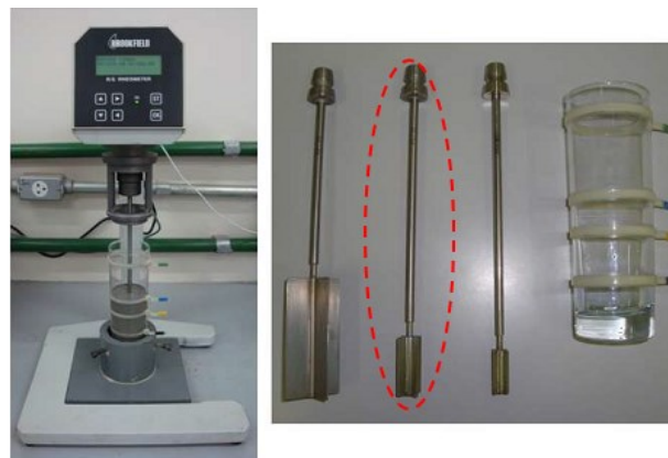
Figura 5: Reômetro R/S e as palhetas do sistema Vane (a palheta destacada corresponde à utilizada no ensaio da argamassa - palheta 40/20) [10].
