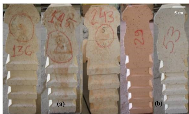
Figura 5: Âncoras cerâmicas sob suspeita no ensaio de ultrassom. Âncoras de teto 136, 145 e 243 (a) e âncoras de parede 29 e 53 (b).
