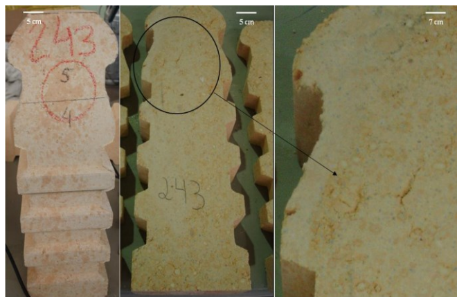
Figura 8: Âncora de teto 243 sob suspeita com presença de trincas internas.
