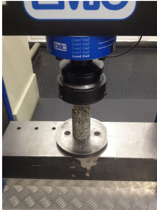
Figura 3: Ensaio de compressão axial, conforme NBR 5739 (fonte: autores)
