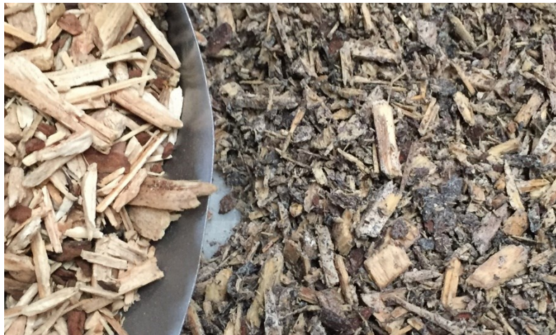
Figura 2: A esquerda material sem tratamento, a direita material carbonatado (fonte: autores)
