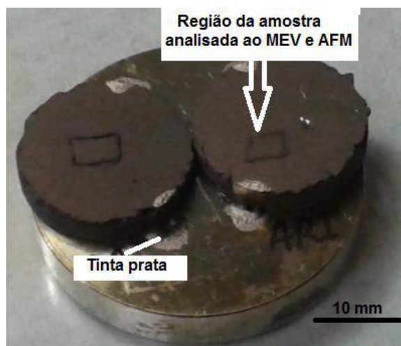
Figura 8: Delimitação com pincel da região das amostras analisadas por MFA (AFM no inglês) e MEV (ver quadrículos marcados). As amostras de pasta de cimento analisadas estão fixadas no porta amostras de alumínio e para garantir o contato elétrico da amostra com o porta amostra foi utilizada tinta prata.
