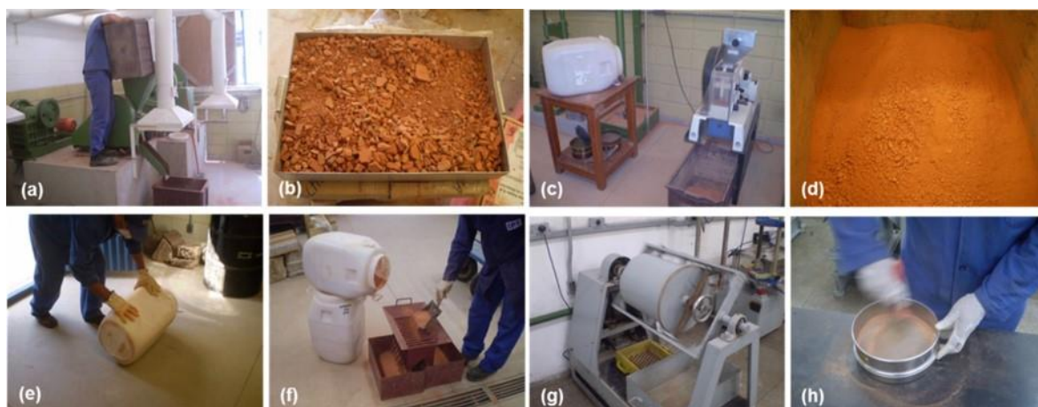
Figura 1: Produção da pozolana – Primeira fase da moagem dos cacos cerâmicos: (a) alimentação do britador de mandíbula, (b) material coletado após a primeira moagem, (c) britador de mandíbula com abertura menor, (d) material resultante das sucessivas moagens, (e) homogeneização e (f) quarteamento do material produzido. Segunda parte da moagem: (g) moagem em moinho de bolas e (h) peneiramento do material moído para verificação do atendimento à especificação.
