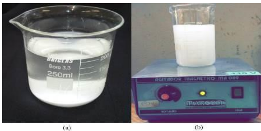
Figura 1: Procedimento de preparo da solução de MCC: (a) MCC em solução de 225 ml de água; (b) MCC durante processo de agitação em agitador magnético.
