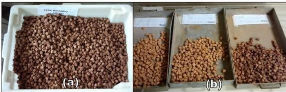
Figura 1: (a) Agregados calcinados com solos utilizados em cerâmicas do Acre em [5]; (b) Agregados produzidos a partir da tabatinga do Acre em [6].
