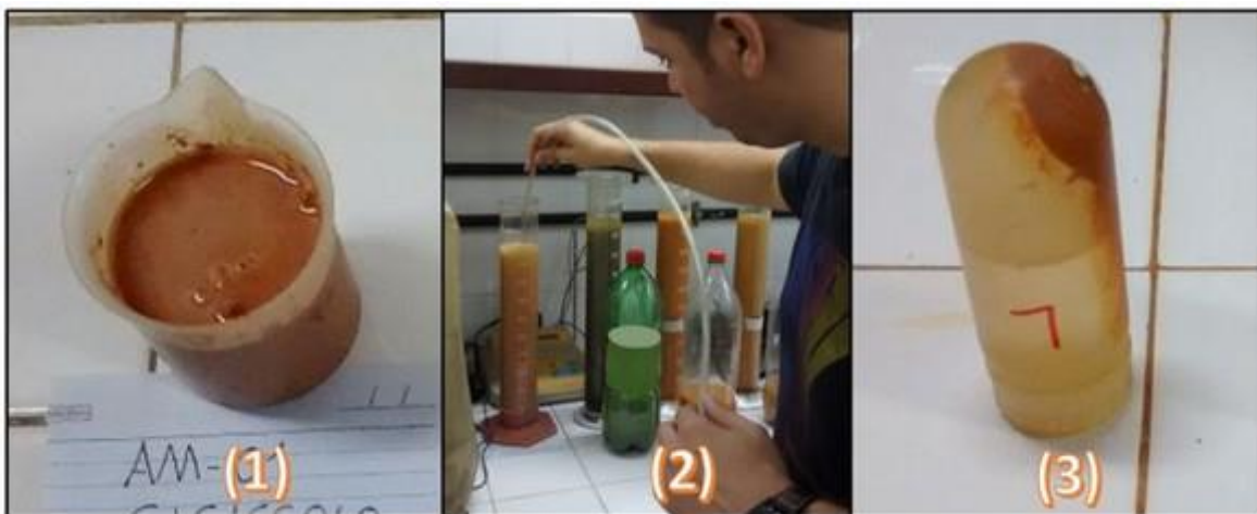
Figura 7: (1) Etapa de defloculação da amostra com a adição de hidróxido de sódio (NaOH 1M) após secagem e destorroamento; (2) Separação da fração argila por sifonamento com o auxílio de tubo plástico; (3) Argila concentrada após centrifugação a 10.000 rotações / min.
