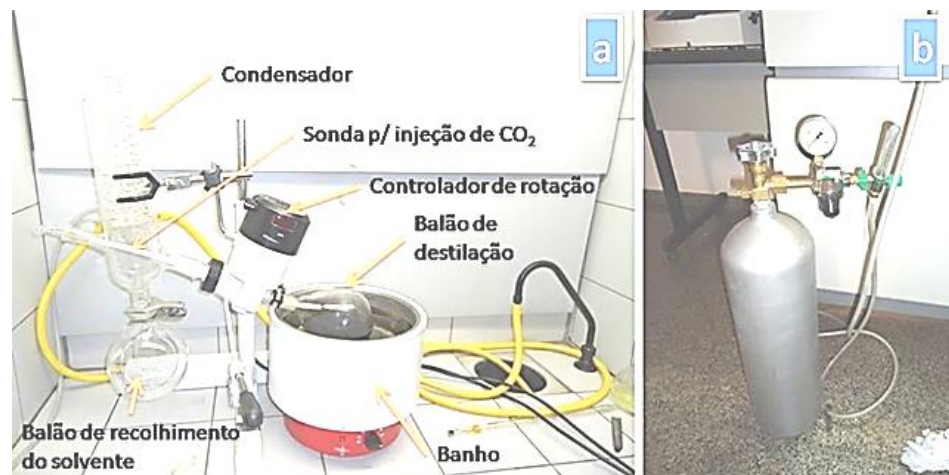
Figura 2: a) Equipamento Rotavaporador (b) Balão de CO 2 .
