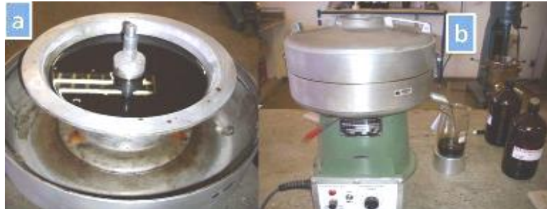
Figura 1: (a) Cuba do Rotarex com a mistura fresado-solvente (b) Equipamento Rotarex
