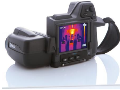
Figure 4: Thermographic camera with infra-red sensor (Source: http://www.contemp.com.br/produto/flir-t440/ ).
