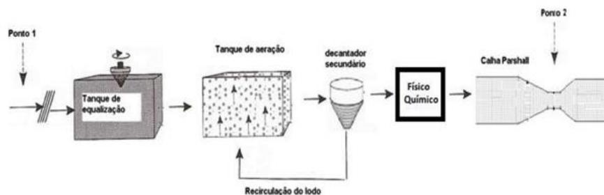
**Figura 1:** Fluxograma da Estação de Tratamento de Efluentes (ETE) da indústria de tinturaria e os pontos de coleta do efluente.
