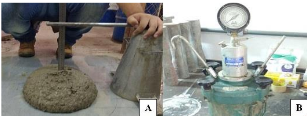
Figura 1: Medições do abatimento do tronco de cone (a), segundo a ABNT NBR NM 67 [17] e do teor de ar incorporado e da massa específica (b), segundo a norma ABNT NBR 9833 [18].
