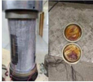
Figura 5: Corpo de prova pronto para ser ensaiado e preparação da superfície de contato com os pratos metálicos.
