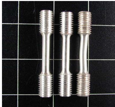
Figura 3: Probetas utilizadas en los ensayos dinámicos.
