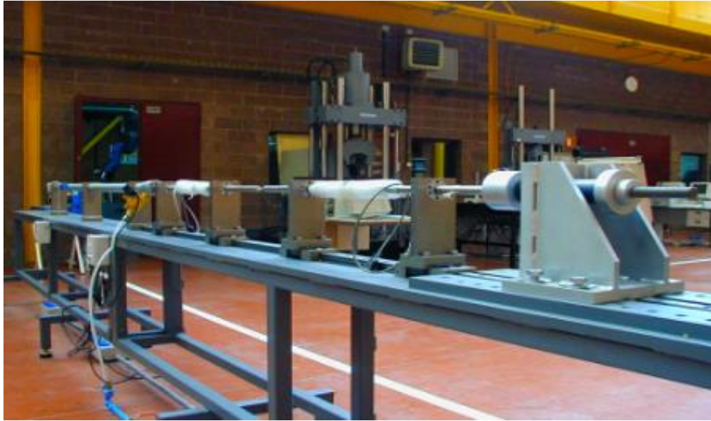
Figura 1: Barra Hopkinson de tracción de la Universidad Carlos III de Madrid.
