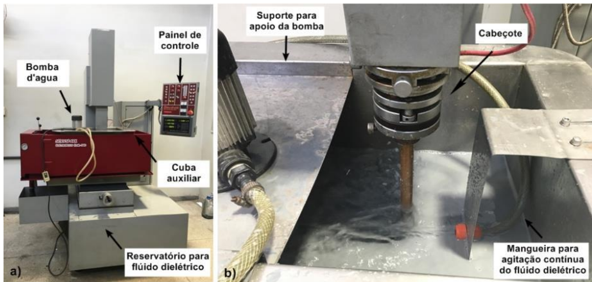
Figura 1: a) Máquina de eletroerosão utilizada no processo NDE b) Detalhes das adaptações realizadas no equipamento.
