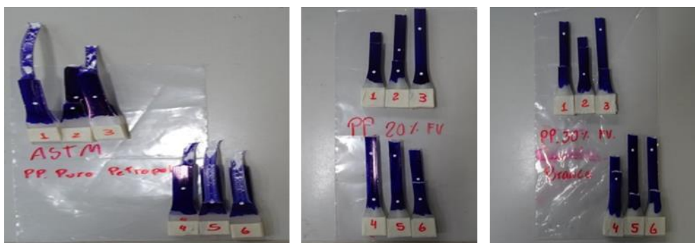
Figura 2: Corpos de prova rompidos (a) PP puro, (b) PP 20% FV e (c) PP 30% FV
