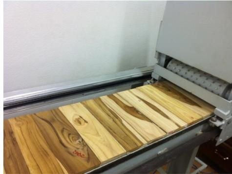
**Figura 3:** Equipamento para ensaio de endentação em pequenas áreas
