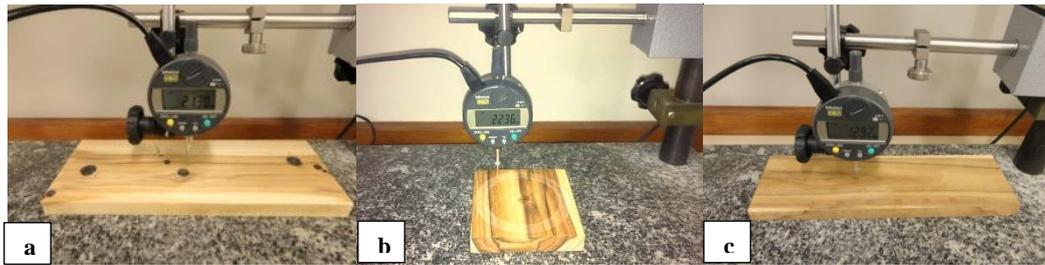
**Figura 5:** Medição da depressão na madeira após ensaios de simulação a) Impacto da esfera de aço, b) Ensaio de abrasão e c) Ensaio de endentação aplicada em pequenas áreas
