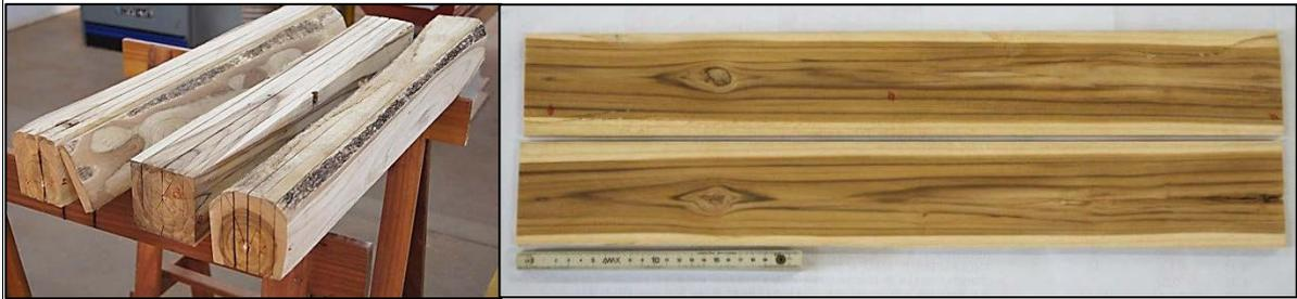
**Figura 1:** Obtenção de tábuas para confecção de pisos de madeira de teca
