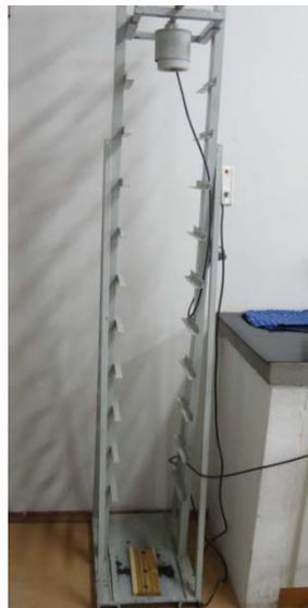
**Figura 4:** Aparelho para ensaio de impacto da esfera de aço
