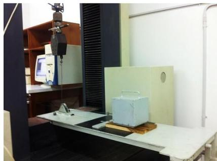
**Figura 7:** Adaptação da máquina universal para determinação do coeficiente de atrito
