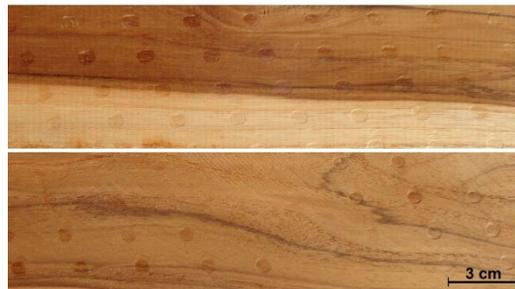
**Figura 10:** Dano moderado na superfície da madeira de teca após o ensaio de endentação em pequenas áreas
