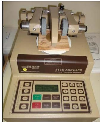
**Figura 6:** Abrasímetro TABER para ensaio de abrasão
