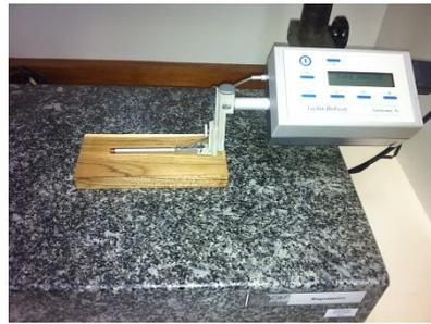
**Figura 8:** Medição da rugosidade da superfície da madeira
