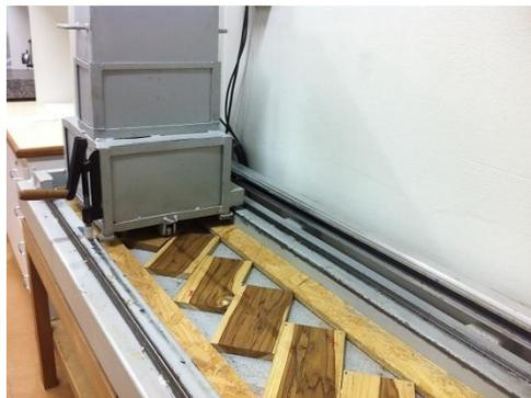
**Figura 2:** Equipamento para ensaio de carga rolante
