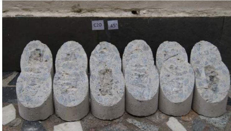
Figura 6: Vista superior dos corpos de prova com resistência almejada de 20 MPa após o corte.
