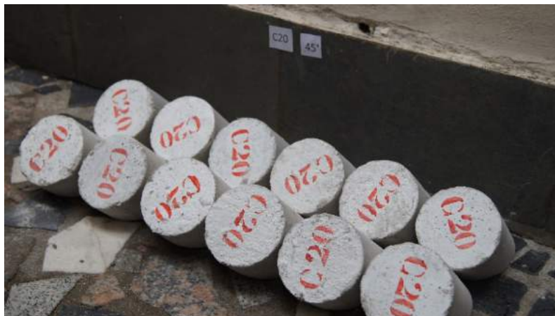
Figura 5: Vista inferior com identificação dos corpos de prova com resistência almejada de 20 MPa.
