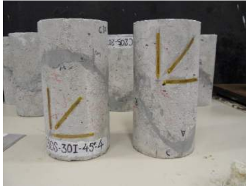
Figura 11: Instrumentação dos corpos de prova com extensômetros elétricos de resistência (EER).
