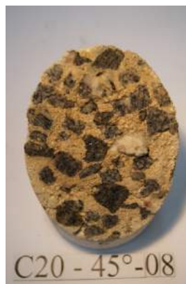
Figura 7: Vista superior do Corpo de prova C20-45°-08 MPa após o corte, regularização e jateamento de água pressurizada por cerca de 15 minutos.
