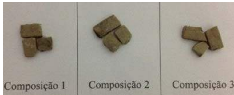
Figura 5: Fotografia dos corpos de prova das composições 1, 2 e 3, na temperatura de sinterização de 1250°C, em que ocorreu a superqueima.
