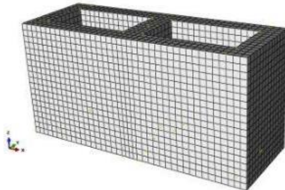
Figura 2: Malha utilizada no bloco de concreto.
