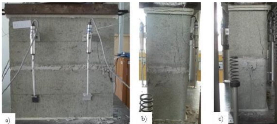
Figura 12: Modo de ruptura do prisma de dois blocos com argamassamento total. Fonte: IZQUIERDO [18]
