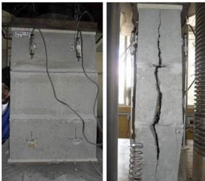
Figura 10: Modo de ruptura do prisma de três blocos com argamassamento parcial. Fonte: OLIVEIRA [10]
