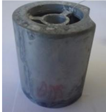
Figura 3: Fotografia da peça de Zamac 5 submetida a ensaio de névoa salina com inclinação de 45°, ciclo de 8h.
