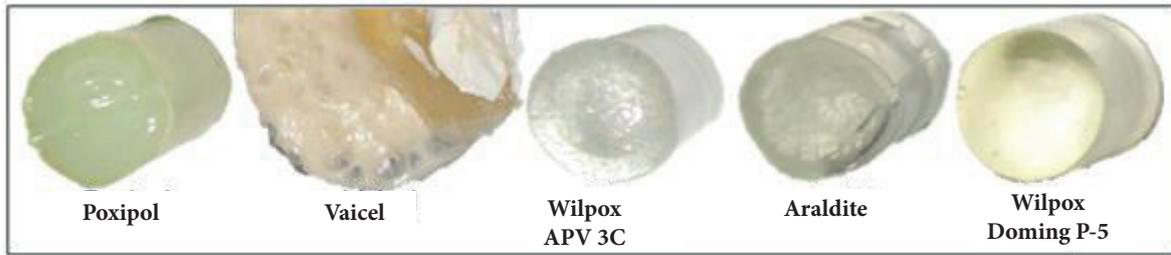
**Figura 10:** Materiales encapsulantes en geometría cilíndrica tras 1 día de inmersión en acetona. El cilindro de Vaicel perdió la forma inicial.
