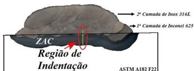
Figura 6: Esquema de realização do ensaio de microdureza nas amostras revestidas.
