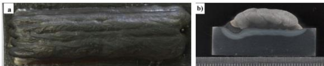
Figura 17: (a) Aspecto superficial e (b) macrografia do revestimento.
