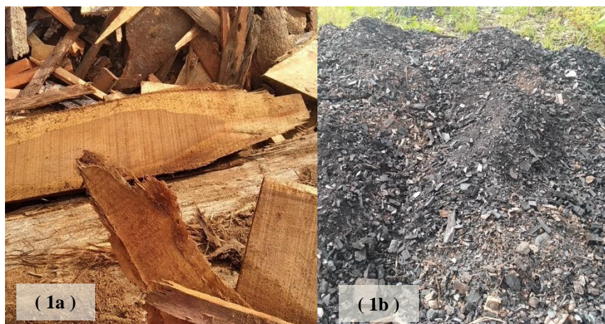
Figura 1: Refugos de beneficiamento de madeira (1a) e CG geradas na carbonização (1b).
