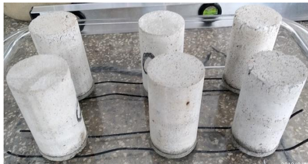
Figura 3: Espécimes sendo preparados para verificação da absorção de água por ascensão capilar.
