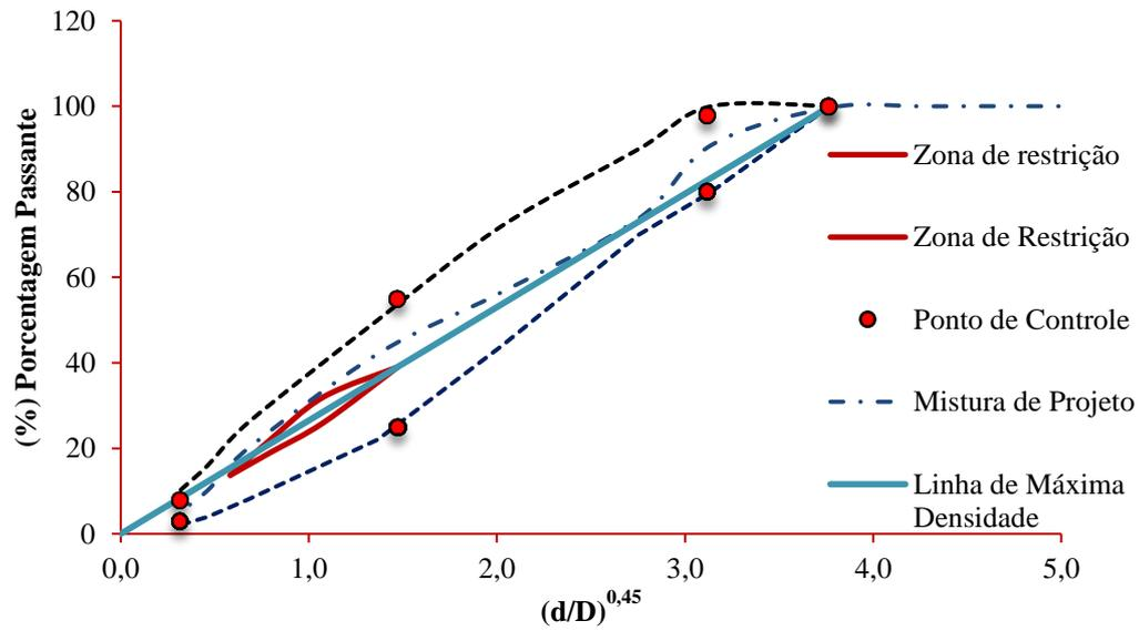
**Figura 4:** Curva de Fuller da Mistura intermediária para a Faixa C do DNIT.
