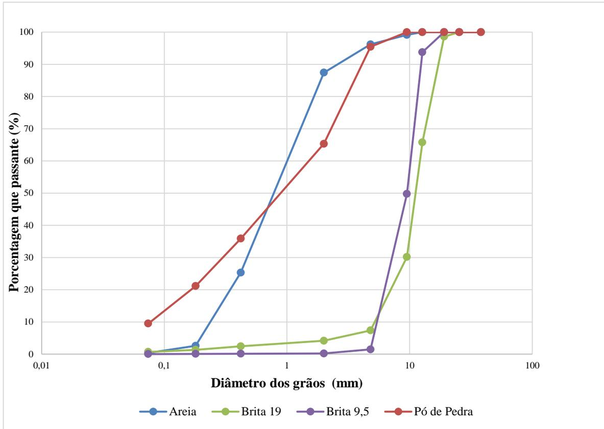
Figura 1: Curva granulométrica dos agregados graúdos e miúdos.
